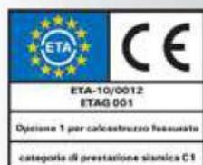
Ulteriori informazioni sulle prestazioni sismiche del sistema di ancoraggio sono indicate sotto il logo della certificazione ETA.
