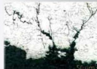
Esempio di corrosione sotto tensione transgranulare sul materiale 1.4401 per l'aggressione di cloruri.
