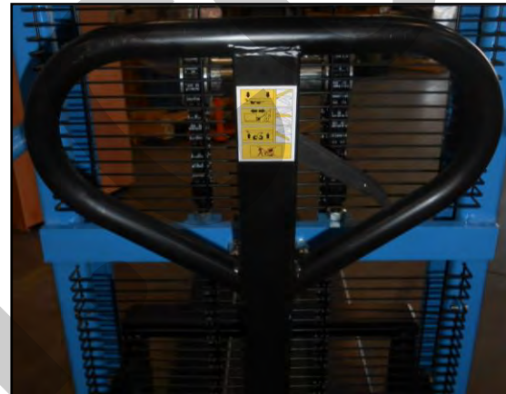
Figura 10 – Dettaglio leva di comando del Transpallet Art. 0143A.
