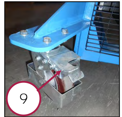
Figura 3 – Dettaglio freni e ripari ruote.
