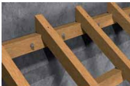
Travi dormienti in legno
