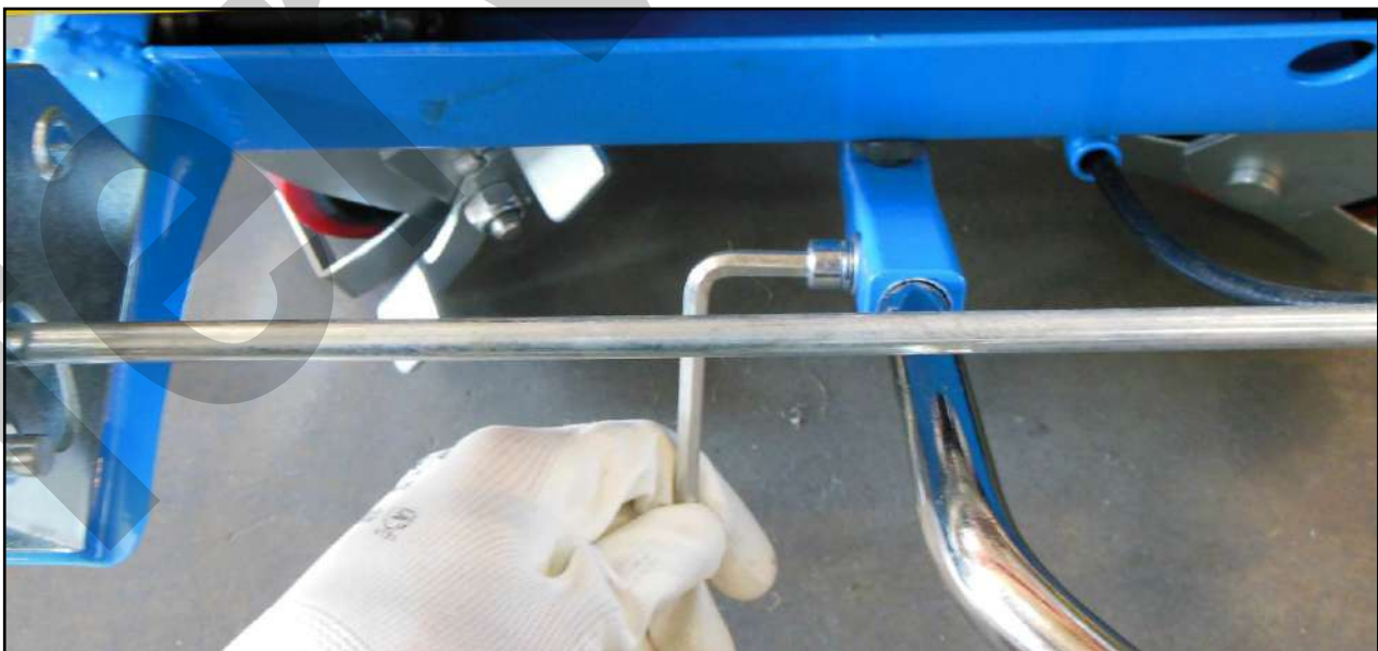
Figura 5 - Montaggio del carrello
