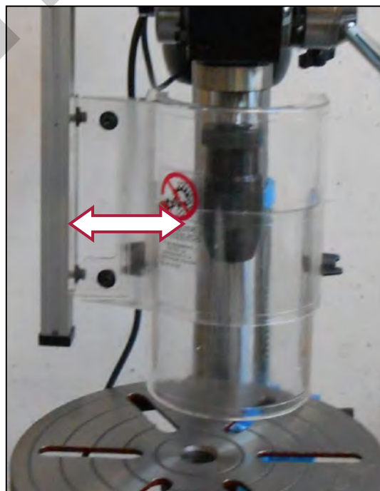
Figura 18 - Scorrimenti del riparo in senso verticale e longitudinale
