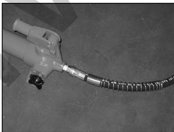
Figura 3 – Protezione tubo flessibile.
