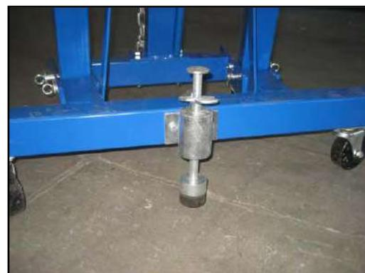
Figura 15 – Sistema di bloccaggio.
