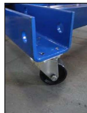
Figura 9 – Installazione ruote telaio fisso.
