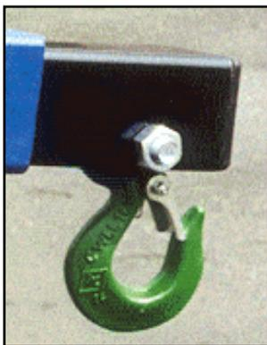
Il **gancio con dispositivo di chiusura di sicurezza**, assicura contro i pericoli dovuti allo sganciamento indesiderato del carico durante le operazioni di sollevamento / abbassamento o di spostamento del carico stesso.
