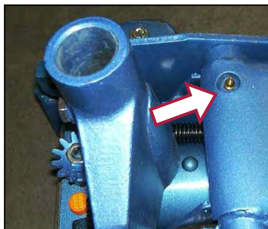
Figura 13 - Parti mobili da lubrificare.
