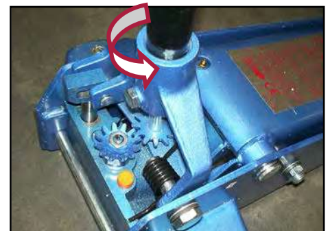
Figura 12 - Apertura valvola di ritegno.
