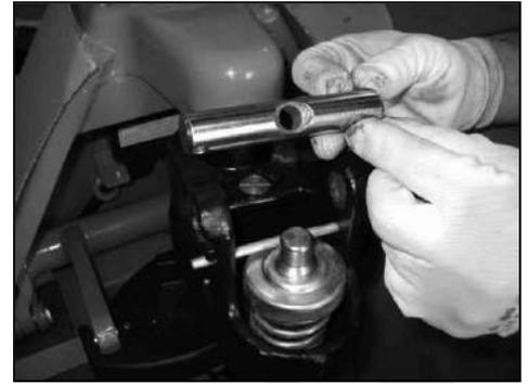
Figura 8 – Posizionamento perno.
