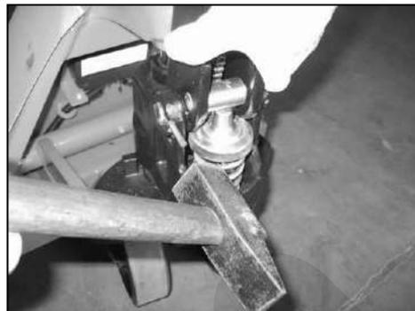
Figura 12 – Bloccaggio spina corta
