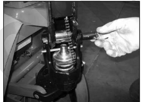
Figura 9 – Inserimento del perno.
