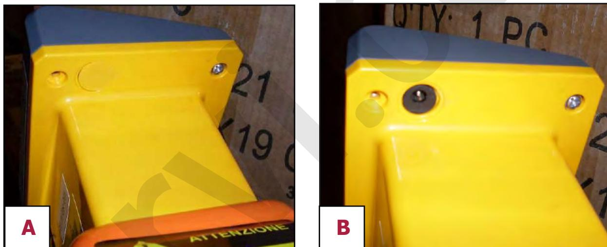
Figura 19 – A: Presa coperta dalla protezione / B: Presa scoperta.
