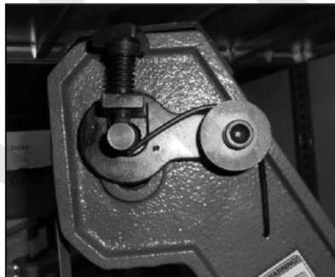
Figura 16 – Vite di tensione del nastro.
