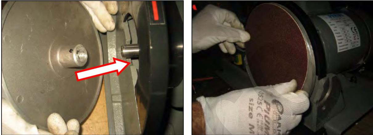
Figura 12 - Montaggio disco
