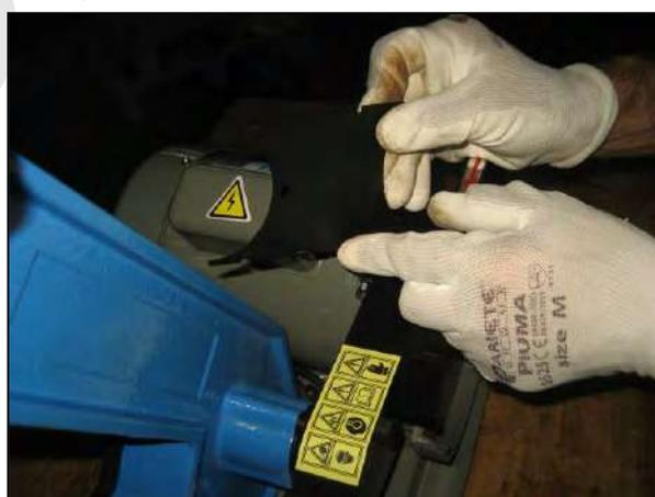
Figura 11 – Montaggio seconda parte del carter della cinghia
