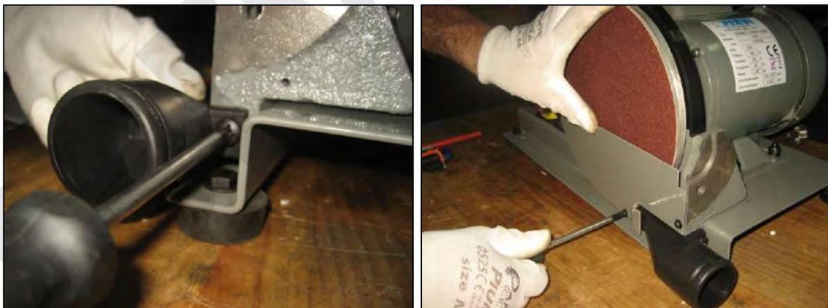
Figura 13 - Montaggio bocchettone e carter
