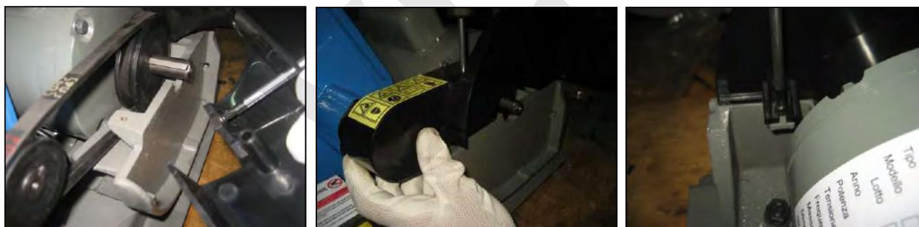
Figura 10 – Montaggio prima parte del carter della cinghia
