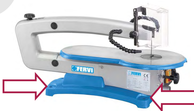
Figura 7 – Fori di fissaggio.
