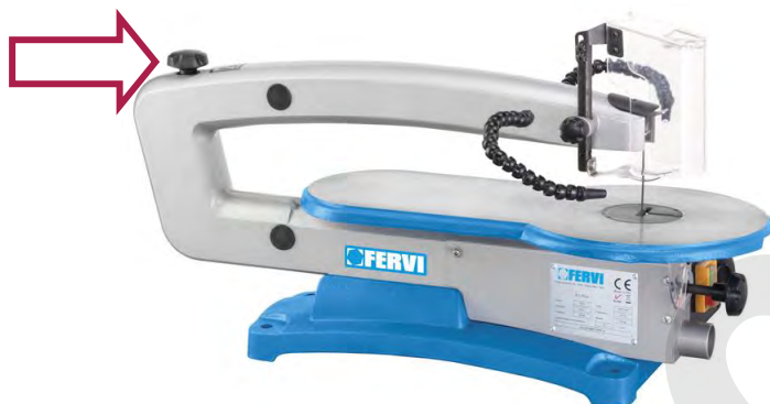
Figura 15 – Comando regolazione tensione della lama.
