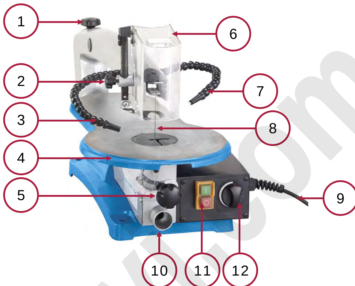
Figura 1 – Vista generale della macchina.
