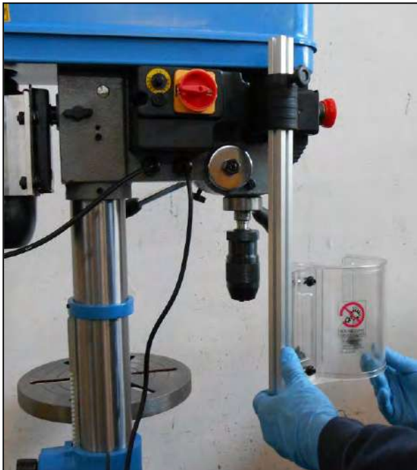
Figura 16 – Inserimento della staffa e posizionamento corretto del riparo
