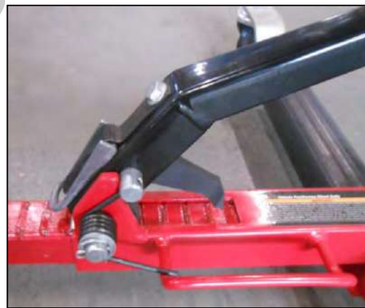
Figura 8 – Meccanismo sbloccato per il rilascio del carico.
