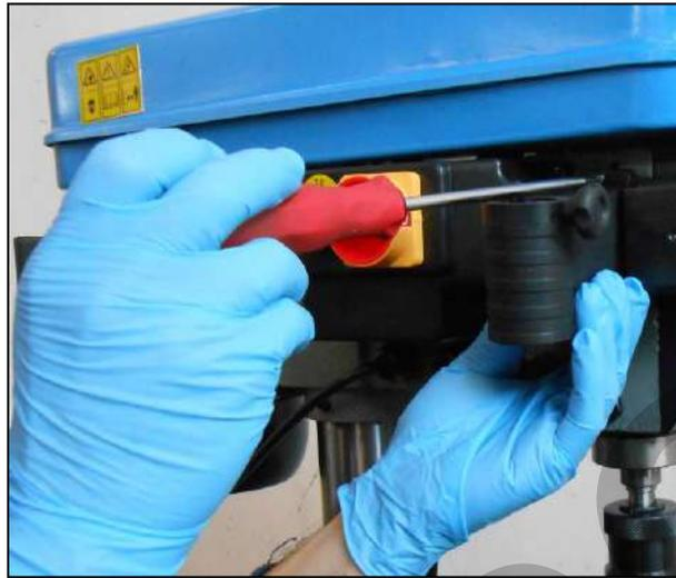
Figura 14 – Montaggio del blocco microinterruttore
