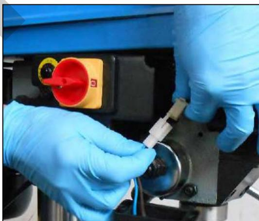
Figura 13 – Collegamento delle connessioni
