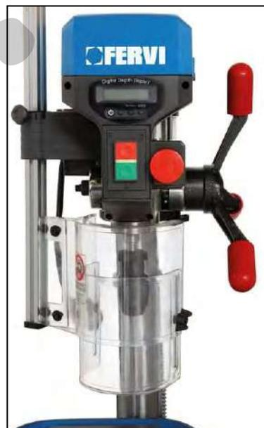
Figura 20 – Inserimento della staffa e posizionamento corretto del riparo
