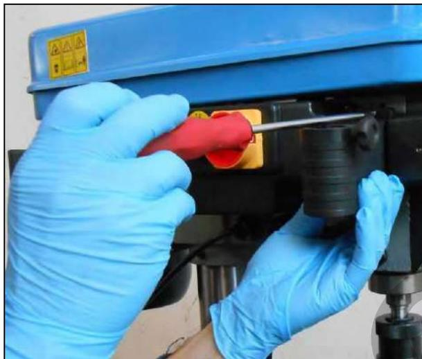
Figura 14 – Montaggio del blocco microinterruttore
