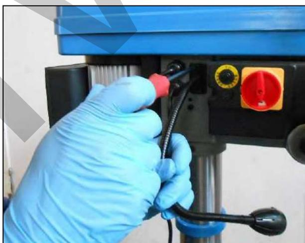
Figura 11 – Montaggio supporto
