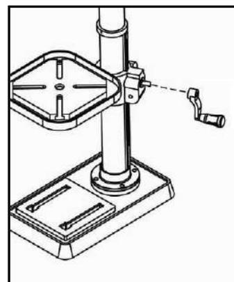
Figura 4 – Assemblaggio Braccio
