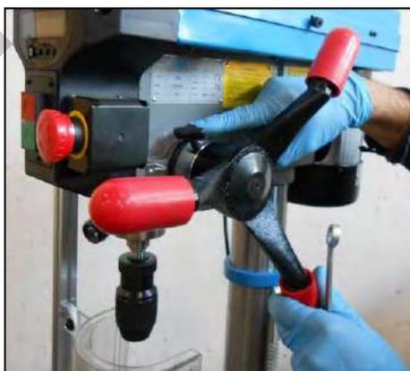
Figura 34 – Vite di blocco corsa mandrino.
