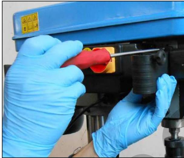
Figura 14 – Montaggio del blocco microinterruttore
