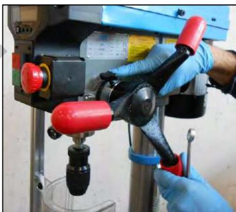
Figura 36 – Vite di blocco corsa mandrino.
