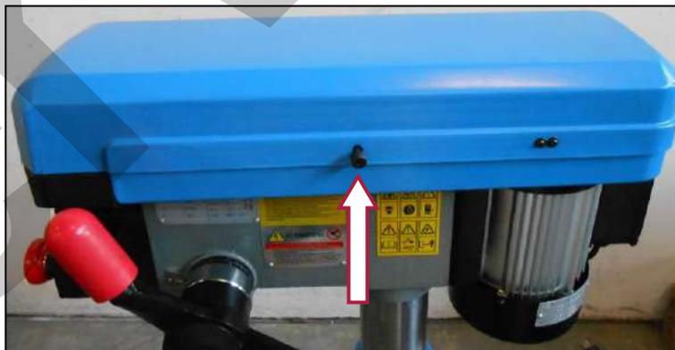
Figura 30 – Vite di bloccaggio del carter.
