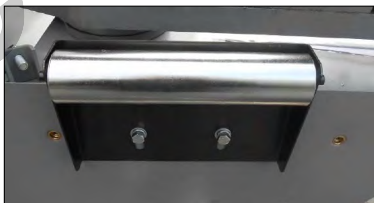
Figura 21 - Rullo di sostegno dei profilati.
