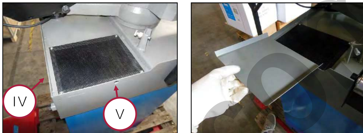
Figura 20 – Installazione della piastra di raccolta del refrigerante.
