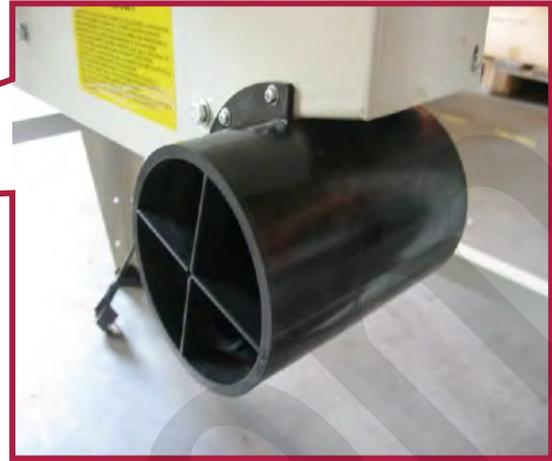
Figura 19 - Montaggio attacco aspiratore.
