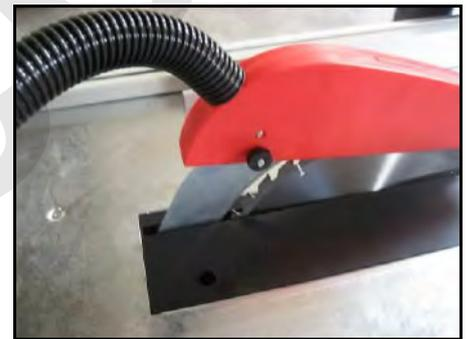
Figura 20 - Montaggio carter copri lama.
