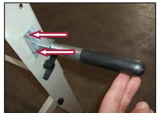
Figura 15 - Fissaggio maniglie.
