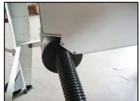
Figura 21 - Collegamento tubazione aspiratore.
