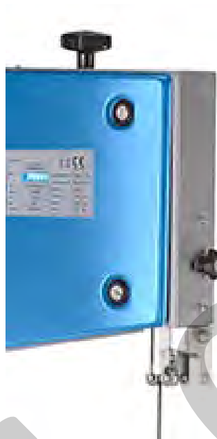
Figura 22 – Carter regolabile di protezione lama.
