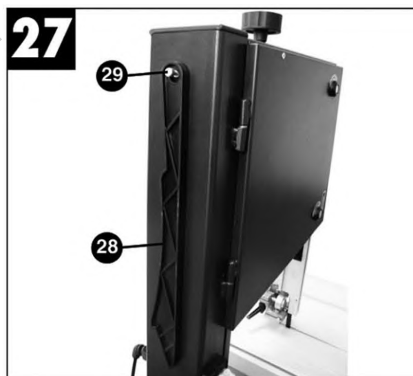
Figura 8 – Montaggio supporto spingipezzo.
