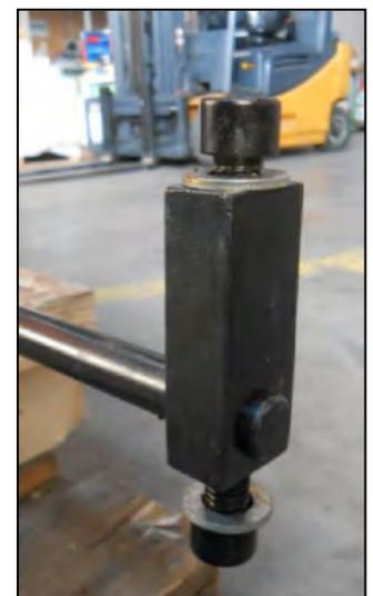
Figura 5 - Fissaggio dell'elemento di collegamento della battuta.
