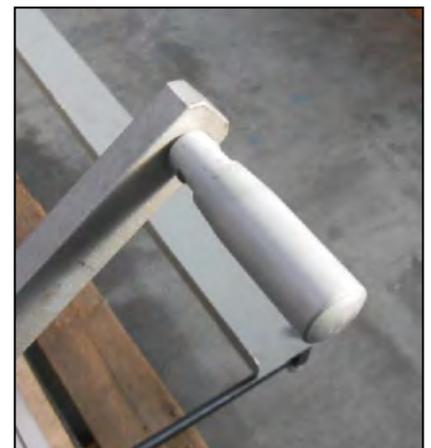
Figura 9 - Pomolo per la movimentazione della leva.
