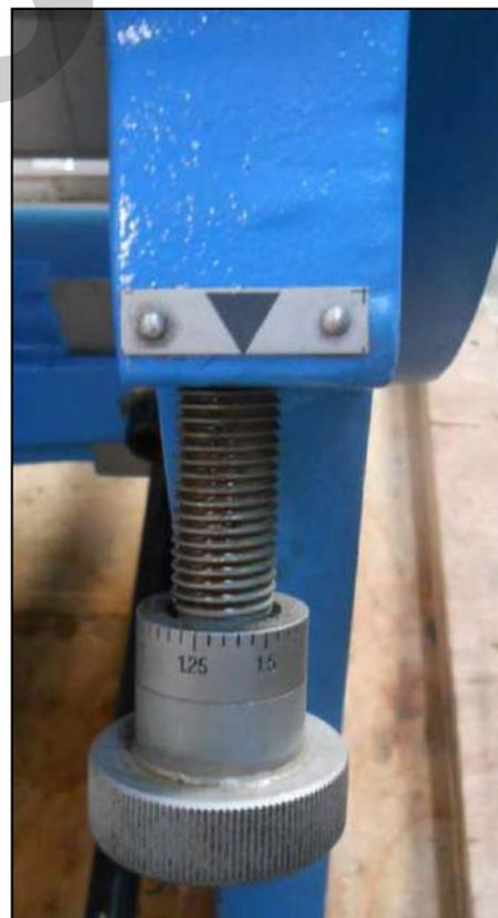
Figura 10 - Pomolo di regolazione diametro/cono della Calandra.
