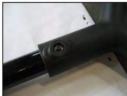
Figura 8 – Installazione della maniglia del cric.
