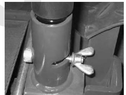
Figura 7 – Installazione della leva del cric.
