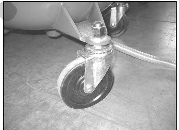
Figura 7 – Ruote pivotanti.
