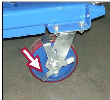
Figura 14 – Sbloccaggio del freno.
