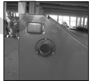
Figura 13 - Attacco al sistema di aspirazione
