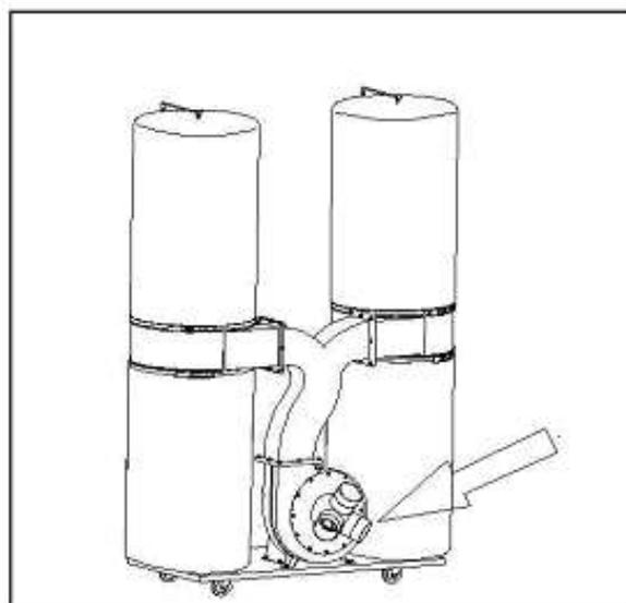
Figura 12- Montaggio flangia aspirazione.
