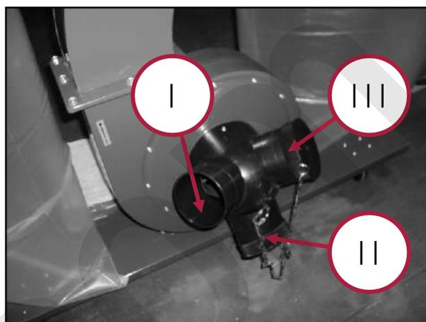
Figura 13 – Attacco del tubo di aspirazione.
