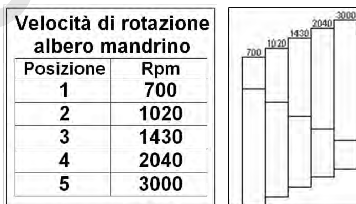
Figura 15 – Targa delle velocità di rotazione.
