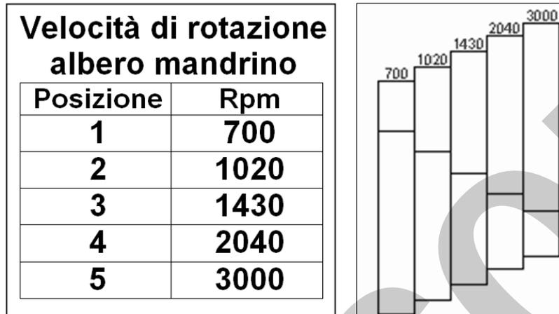
Figura 9 – Targa delle velocità di rotazione.
