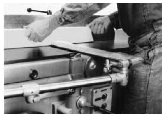
Figura 31 – Piallatura con guida inclinata a 45°.
