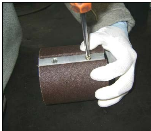
Figura 34 – Rimozione della carta usurata.
