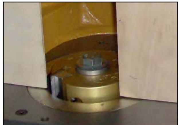
Figura 14 – Fissaggio utensile.
