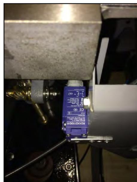
Figura 7 - Microinterruttore carter lama inferiore
