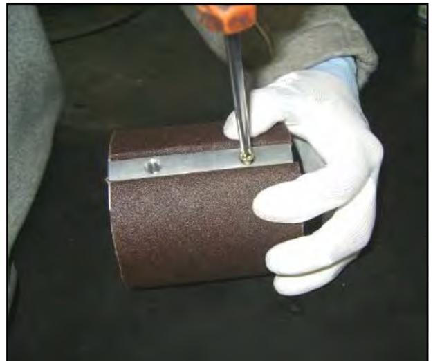
Figura 17 - Rimozione della carta usurata.
