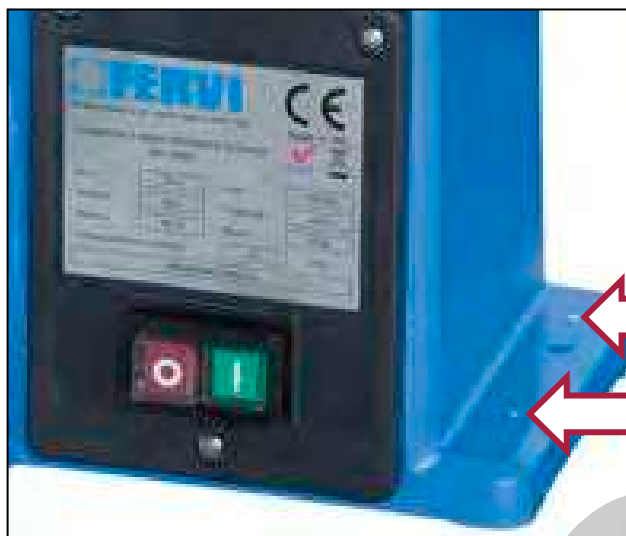
Figura 10 – Dettaglio fori di fissaggio.
