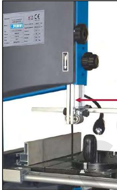
Figura 20 – Carter regolabile di protezione lama.
