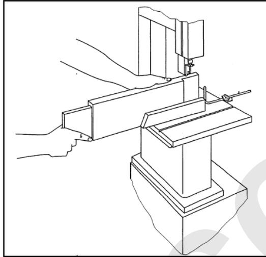
Figura 27 – Esecuzione di scanalature.
