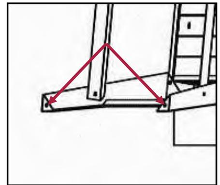
Figura 23 – Fissaggio al suolo.
