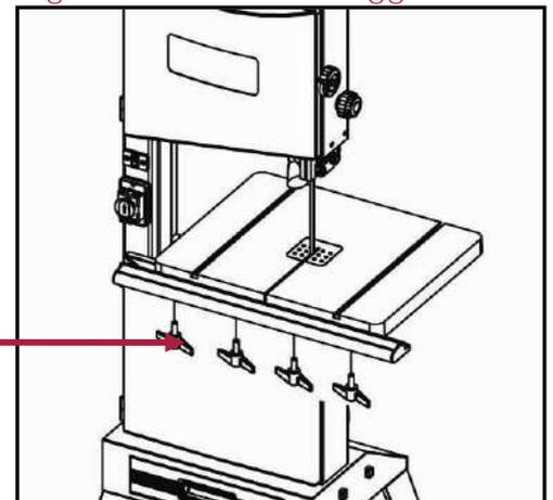
Figura 11 – Traversa guida.
