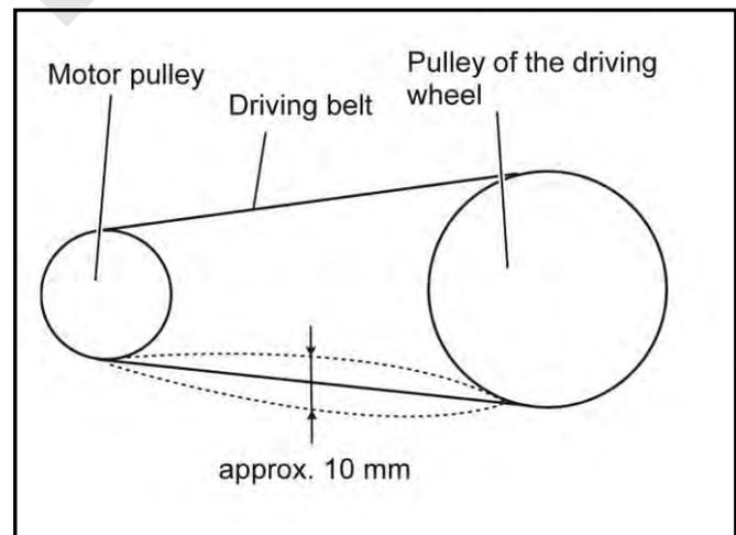
Figura 19 – Cambio velocità e tensionamento cinghia di trasmissione.
