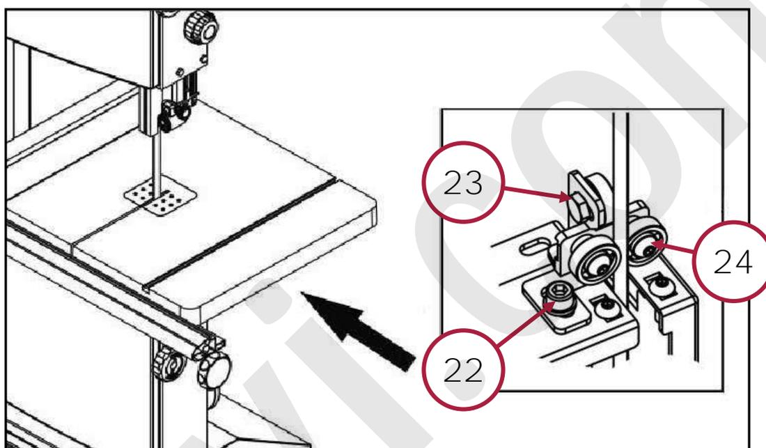
Figura 18 – Regolazione cuscinetti guida lama inferiore
