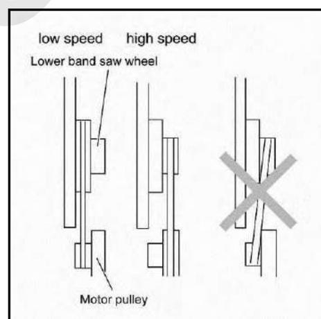
Figura 20 – Cambio velocità e tensionamento cinghia di trasmissione.
