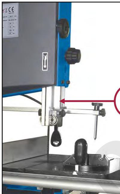
Figura 22 – Carter regolabile di protezione lama.
