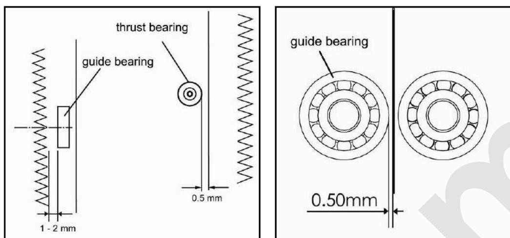
Figura 18 – Regolazione cuscinetti guida lama superiore
