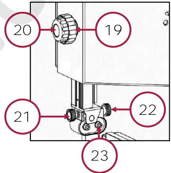
Figura 17 - Guida lama superiore
