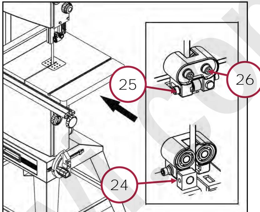
Figura 19 - Regolazione cuscinetti guida lama inferiore
