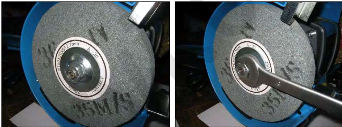
Figura 17 – Dado e flangia di fissaggio della mola.
