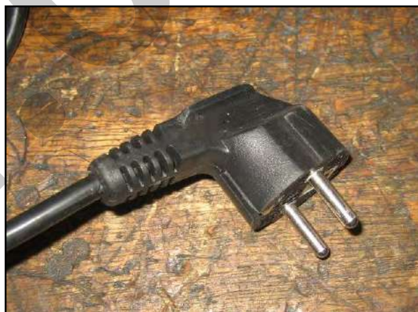
Figura 9 – Particolare spina di alimentazione.
