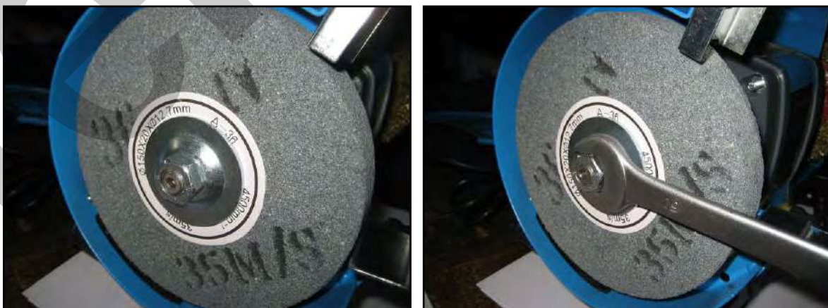
Figura 18 – Dado e flangia di fissaggio della mola.
