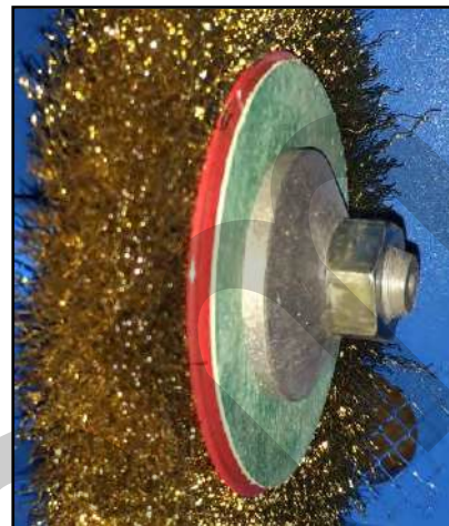
Figura 18 – Dado e flangia di fissaggio.
