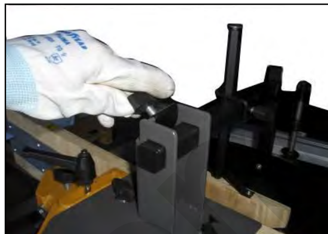
Figura 22 – Regolatori spintore superiore e anteriore.
