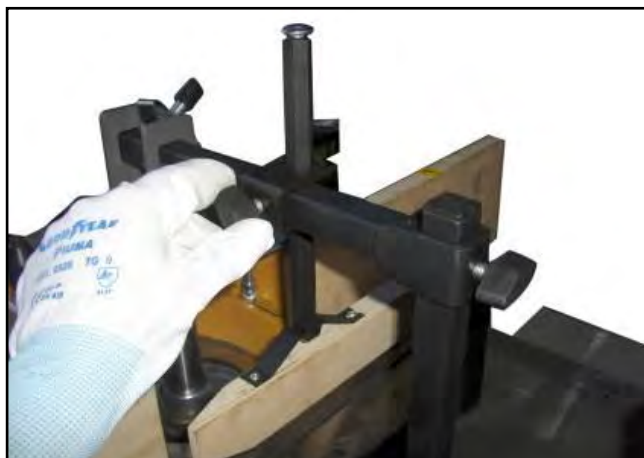
Figura 22 – Regolatori spintore superiore e anteriore.
