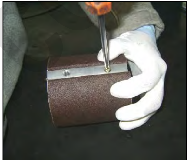
Figura 32 – Rimozione della carta usurata.
