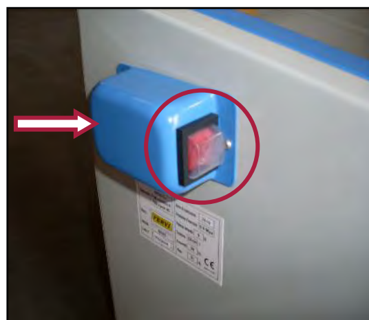
Figura 5 - Dettaglio interruttore e presa per spinotto.
