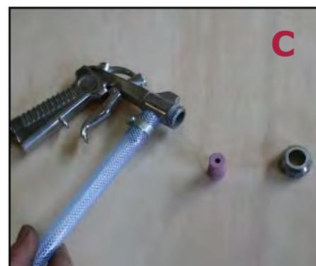
Figura 17 - Smontaggio dell'ugello della pistola sabbiatrice.
