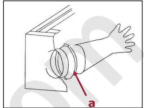
Figura 18 - Sostituzione dei guanti.
