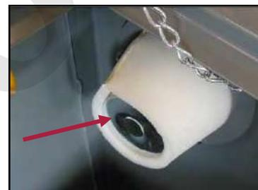
Figura 14 - Attacco al sistema di aspirazione
