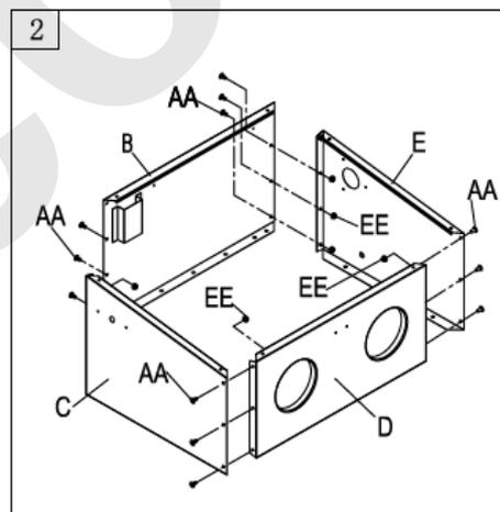
Figura 6 – Assemblaggio cabinet.
