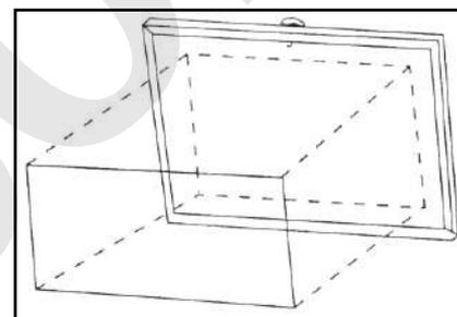
Figura 16 - Pellicola di PVC sostituibile.
