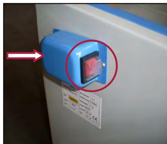
Figura 13 - Dettaglio interruttore e presa per spinotto.
