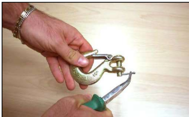
Figura 12 – Sfilare la coppiglia / sfilare il perno.
