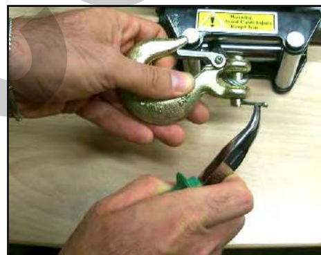
Figura 13 – Collegamento del gancio al cavo.
