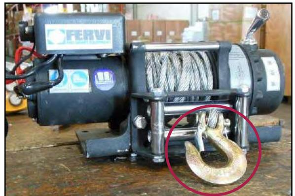
Figura 6 – Guida cavo / montaggio del guida cavo.
