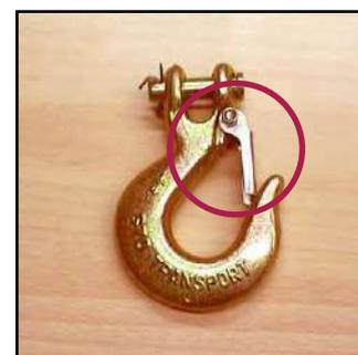
Figura 4 – Dispositivo di chiusura.
