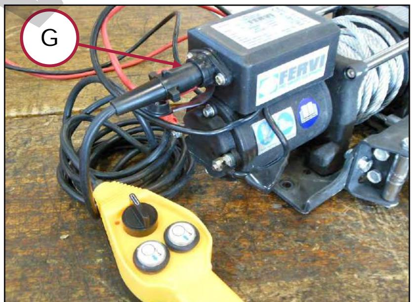
Figura 9 – Collegamento della pulsantiera all'argano.
