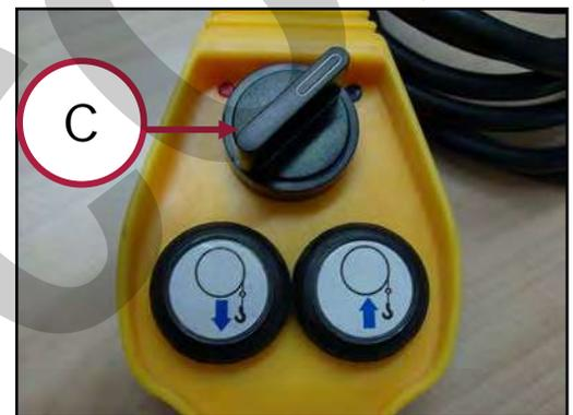
Figura 19 – Selettore velocità di rotazione.
