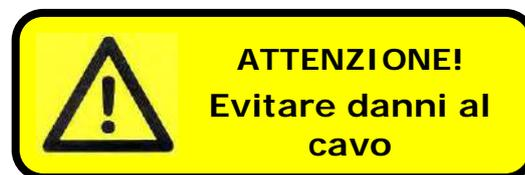
Sul corpo motore, in prossimità della leva della trasmissione, è presente una etichetta di avvertenza, come mostrato qui a fianco.
