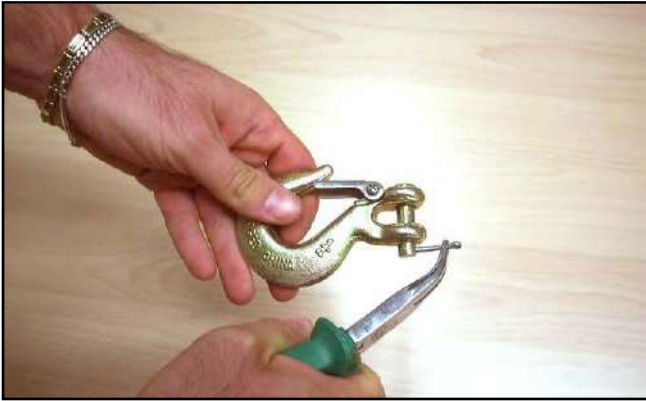
Figura 12 – Sfilare la coppiglia / sfilare il perno.
