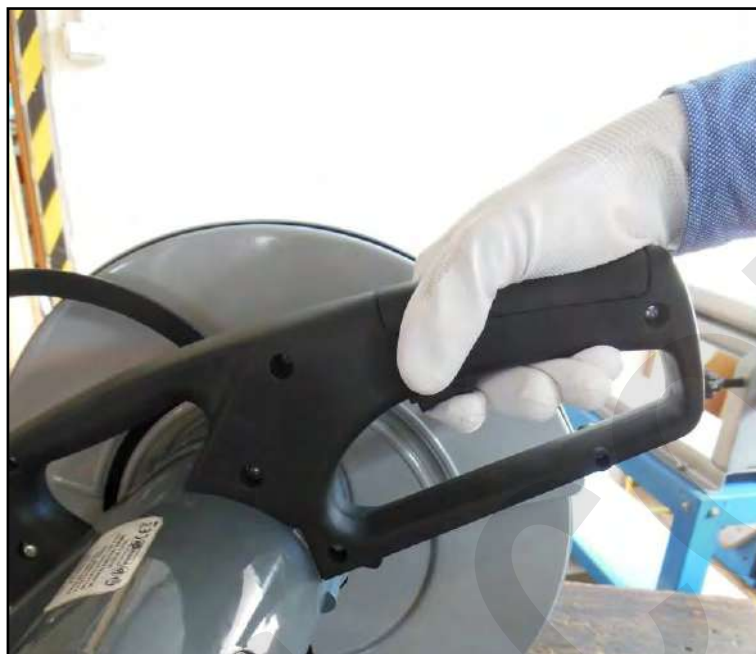
Figura 4 – Azionamento degli interruttori.
