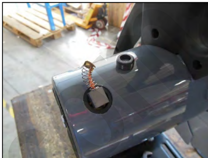
Figura 12 – Sostituzione delle spazzole.
