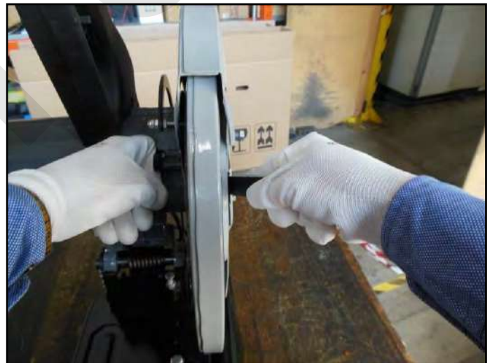
Figura 15 – Rimozione dado di blocco del disco.
