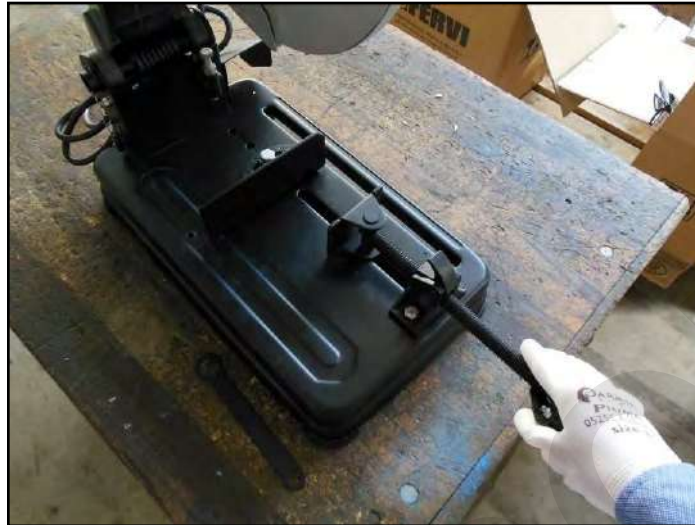
Figura 9 – Fissaggio del pezzo nella morsa.
