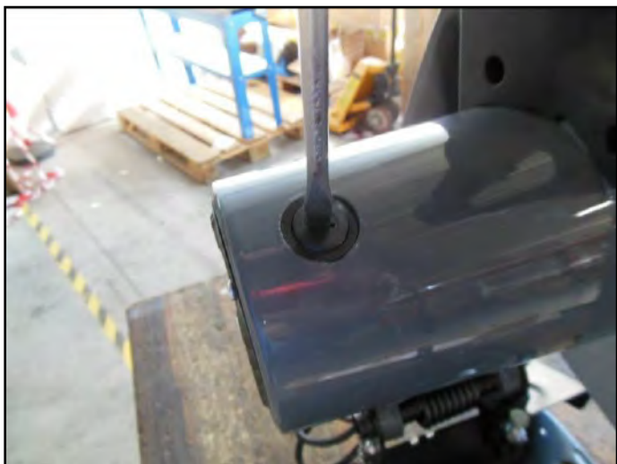
Figura 12 – Sostituzione delle spazzole.
