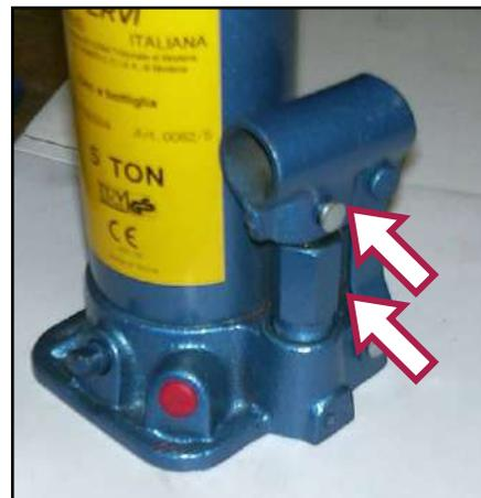
Figura 12 – Perna e cerniere della pompa.
