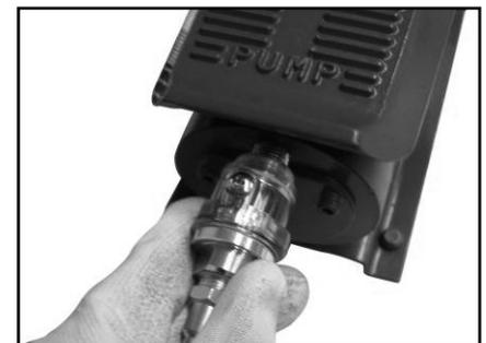
Figura 6 – Raccordo aria compressa.
