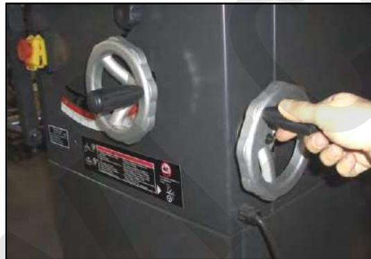
Figura 36 - Regolazione inclinazione lama.
