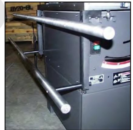
Figura 24 - Montaggio sbarre.
