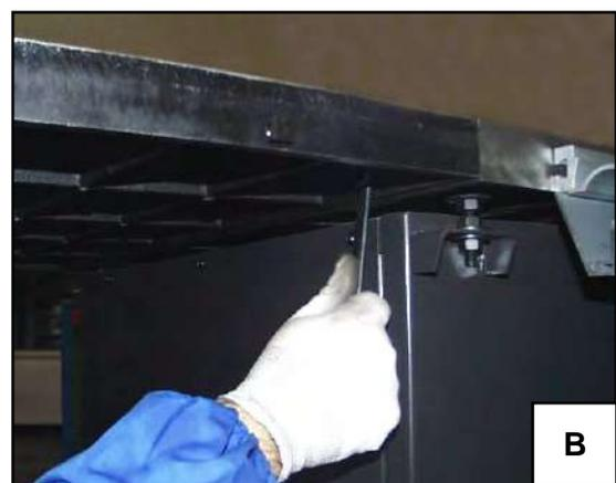
Figura 14 - Montaggio estensione tavola (A: posizione tavole - B: serraggio bulloni)
