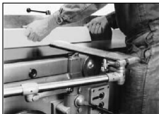
Figura 34 – Piallatura con guida inclinata a 45°.
