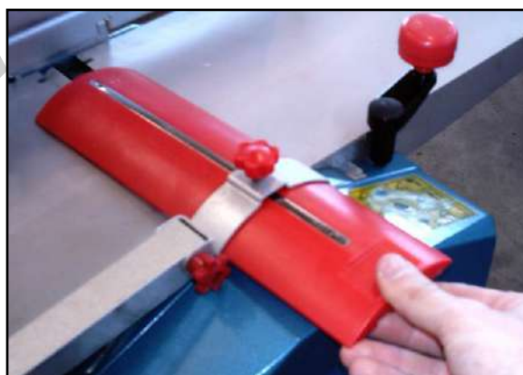
Figura 21 – Regolazione del riparo sull'albero pialla.
