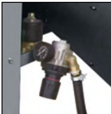
Figura 10 – Attacco dell'aria compressa.
