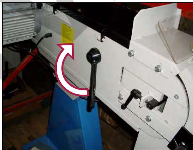
Figura 18 – Rilascio della tensione.
