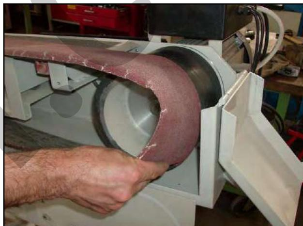
Figura 22 – Inserimento del nastro.
