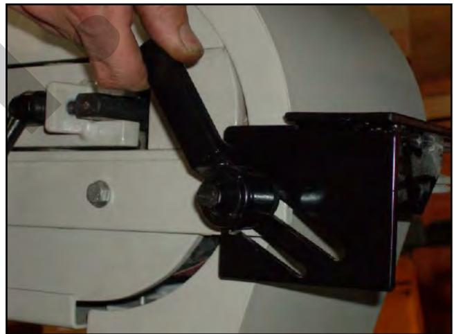
Figura 15 – Montaggio appoggio-pezzo anteriore.
