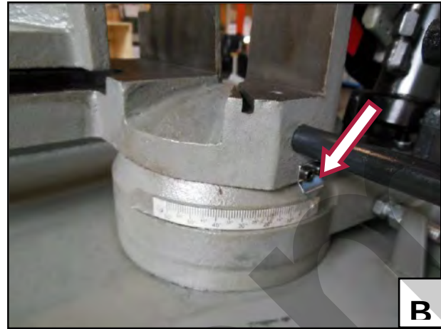
Figura 26 – Regolazione della posizione della testa.
