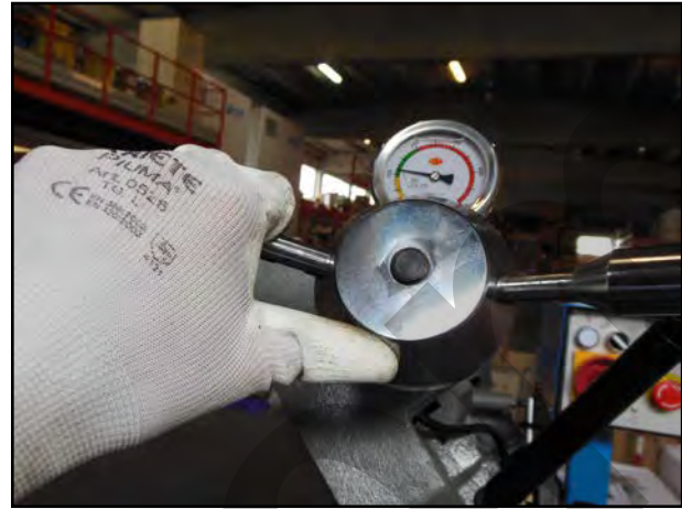
Figura 39 – Montaggio della lama e regolazione della tensione.
