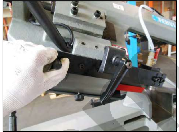
Figura 30 – Regolazione della posizione del guida lama.
