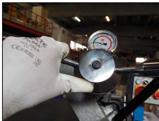
Figura 38 – Riduzione tensione lama.
