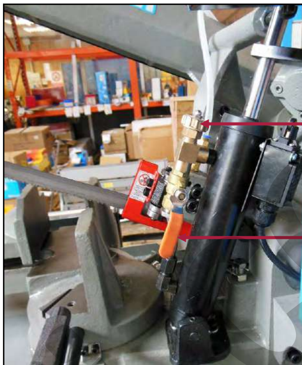
Figura 6 – Comandi di controllo velocità di discesa.
