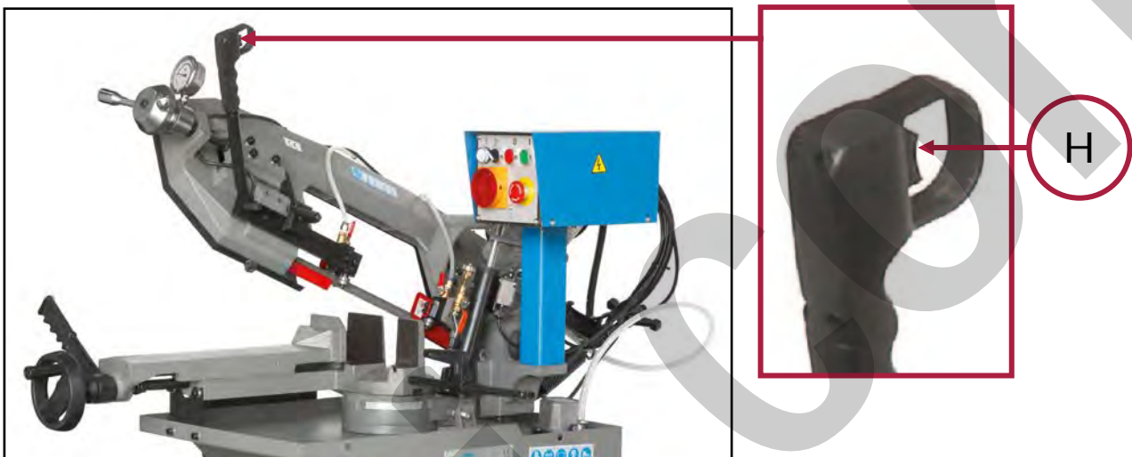
Figura 5 – Pulsante di avviamento lama, in modalità manuale.
