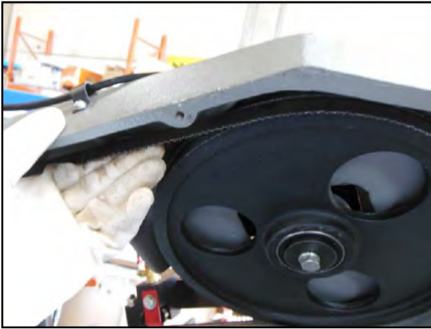
Figura 39 – Montaggio della lama e regolazione della tensione.
