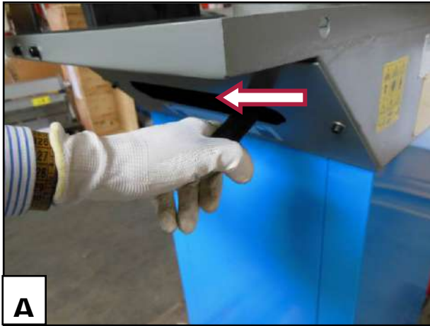
Figura 26 – Regolazione della posizione della testa.
