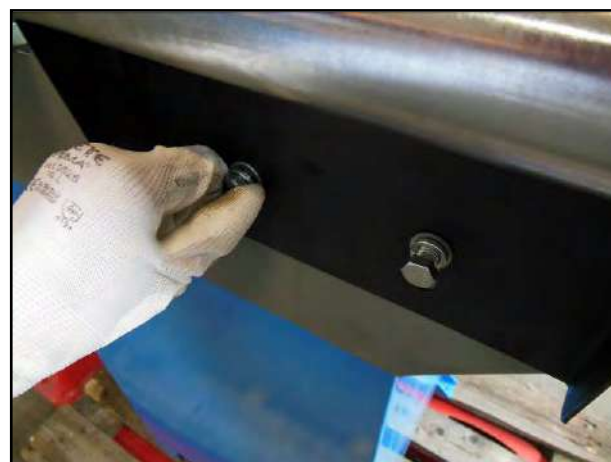
Figura 24 – Installazione del rullo di sostegno dei profilati.
