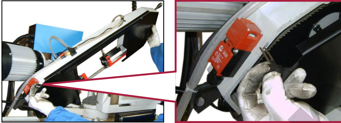
Figura 38 – Smontaggio del carter di protezione lama.
