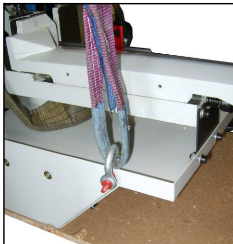
Figura 18 – Sollevamento del basamento della macchina.
