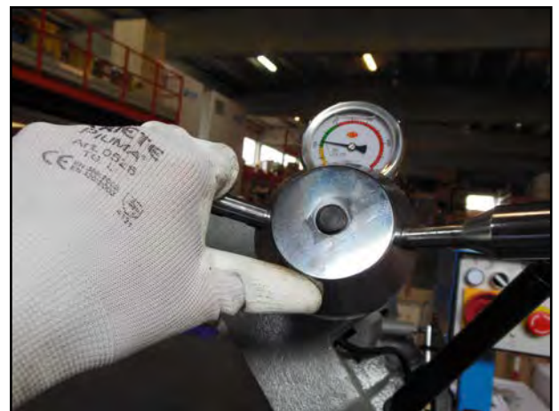
Figura 40 – Riduzione tensione lama.
