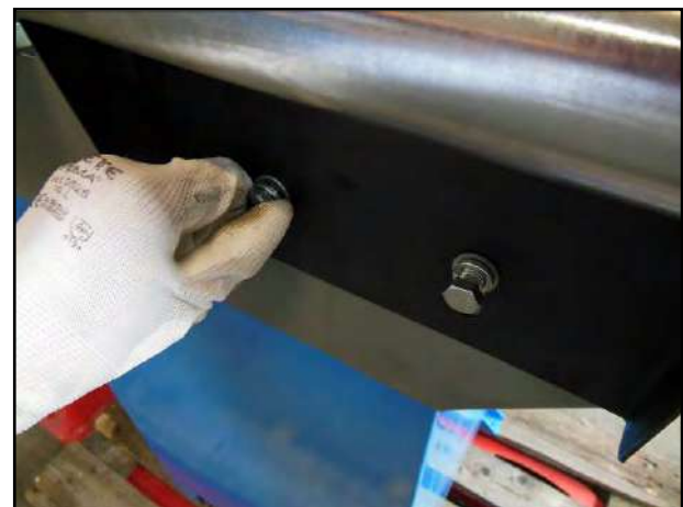
Figura 24 – Installazione del rullo di sostegno dei profilati.
