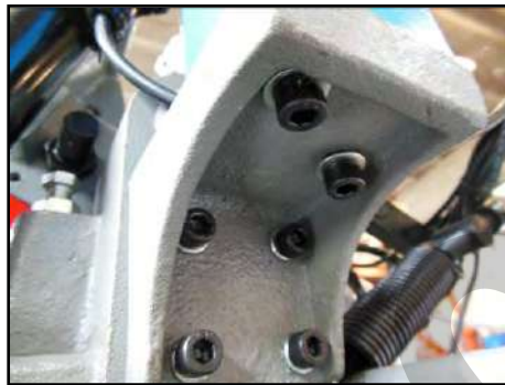
Figura 16 – Dettaglio fissaggio del quadro elettrico.
