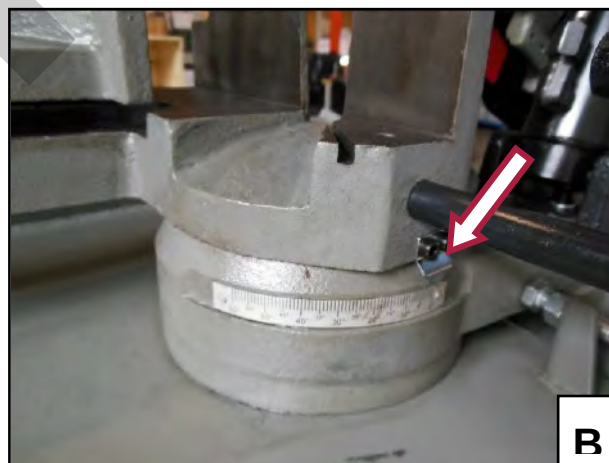
Figura 28 – Regolazione della posizione della testa.
