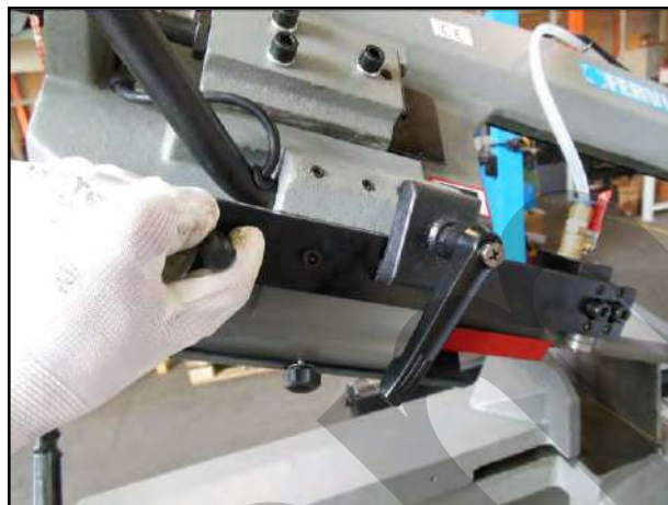
Figura 32 – Regolazione della posizione del guida lama.
