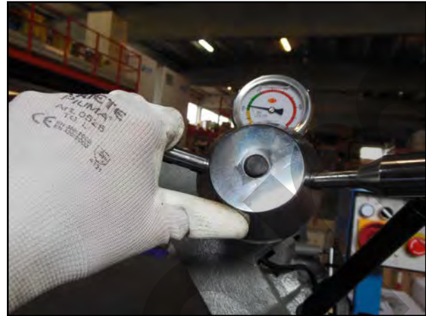
Figura 41 – Montaggio della lama e regolazione della tensione.
