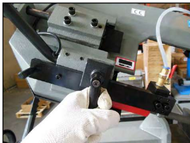
Figura 31 – Sbloccaggio vite del guida lama.
