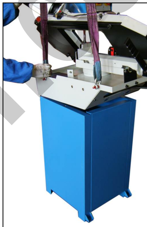
Figura 19 – Allineamento delle due parti.
