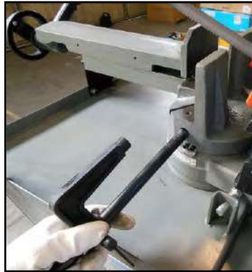
Figura 25 – Installazione dell'asta di riferimento.
