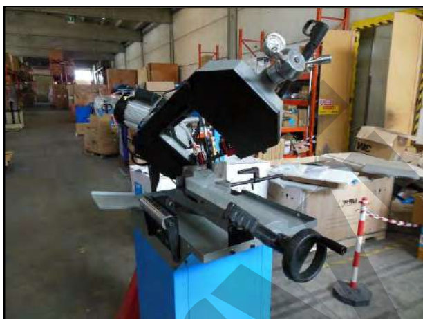
Figura 30 – Regolazione e bloccaggio della morsa.
