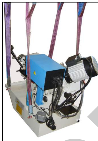
Figura 18 – Sollevamento del basamento della macchina.
