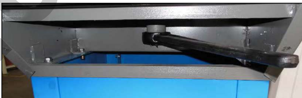
Figura 21 – Fissaggio del basamento alla base di appoggio inferiore.
