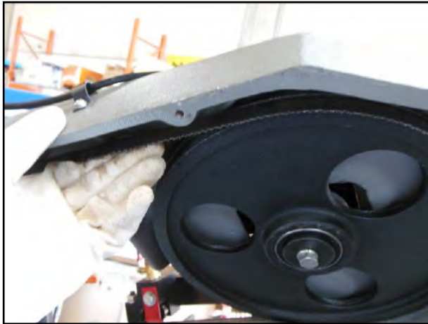
Figura 41 – Montaggio della lama e regolazione della tensione.
